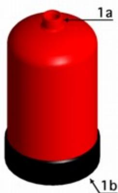
Il serbatoio (vedi figura 2) è normalmente in materiale metallico (acciaio o alluminio nella maggior parte dei casi), ottenuto per caladratura, imbutitura e saldatura o per estrusione, e poggia su una *base 1b* che può essere integrale al serbatoio o, come in figura, applicata esternamente, ma è comunque necessaria per consentire lo stabile appoggio a terra; la *ghiera 1a*, di solito filettata internamente, consente la connessione alla valvola.
